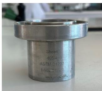
**Figure 1.** Une coupe de viscosité
