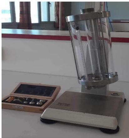
**Figure 5.** Viscosimètre à chute de bille type C
