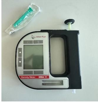
**Figure 3.** Un densimètre portable
