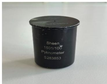
**Figure 2.** Pycnomètre
